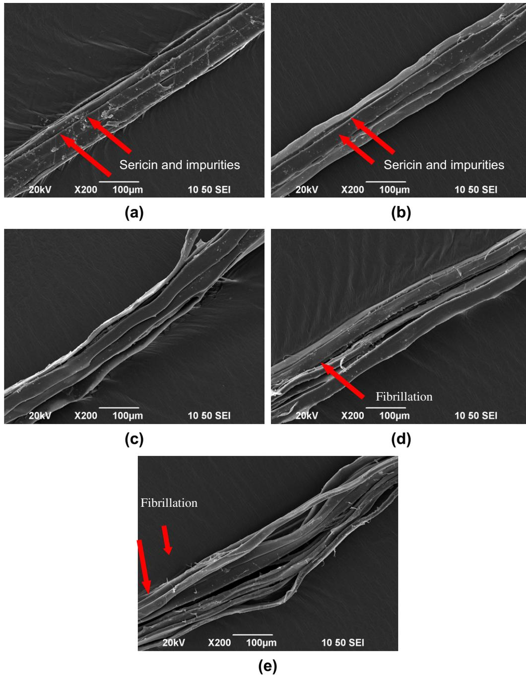
**Fig. 2.** Surface of tussah silk fibres degummed for (a) 0 min (control sample), (b) 15 min, (c) 30 min, (d) 45 min, and (e) 60 min.
